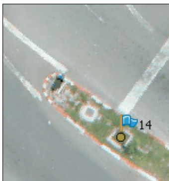
Slika 6. Označavanje kontrolnih točaka (GCP)
