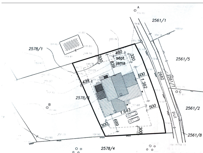
Slika 1. Situacija građevine na geodetskoj podlozi
