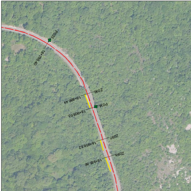
Slika 5. Prikaz objekata na trasi ceste nakon obrade i izvoza podataka iz GIS alata u CAD alat
