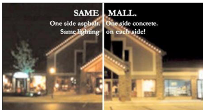
Slika 5. Noćna vidljivost na asfaltnom (lijevo) i betonskom (desno) kolniku pri istoj osvjetljenosti
