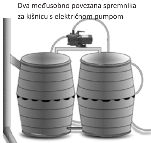
Slika 10. Spremnici za kišnicu sa električnom pumpom [11, 28]
