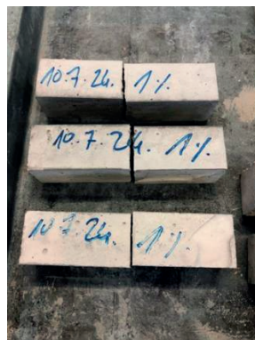
Slika 9. Serija uzoraka nakon ispitivanja vlačne čvrstoće savijanjem
