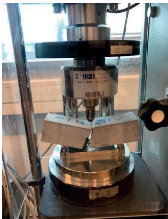
Slika 8. Ispitivanje vlačne čvrstoće savijanjem
