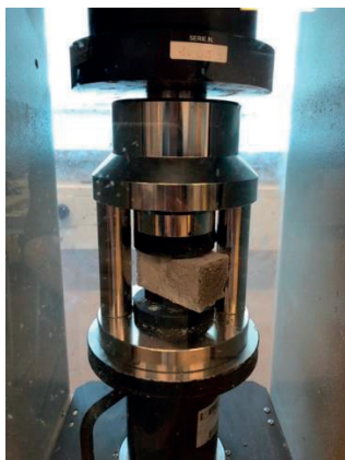
Slika 11. Ispitivanje tlačne čvrstoće
