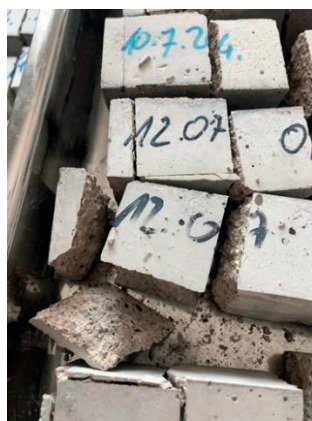
Slika 12. Uzorci nakon ispitivanja tlačne čvrstoće
