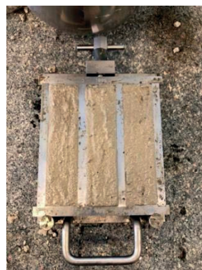
Slika 2. Cementni mort ugrađen u standardni kalup
