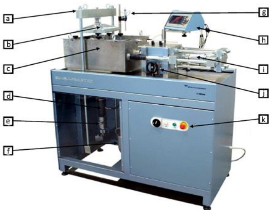
Slika 3. Uređaj za izravan posmik s velikim okvirom za smicanje proizvođača Wykeham Farrance [3].
