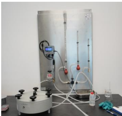
Slika 3. Uređaj za ispitivanje plinopropusnosti metodom Cambureau
