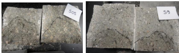
Slika 1. Dubina prodiranja vode na ispitanim uzorcima
