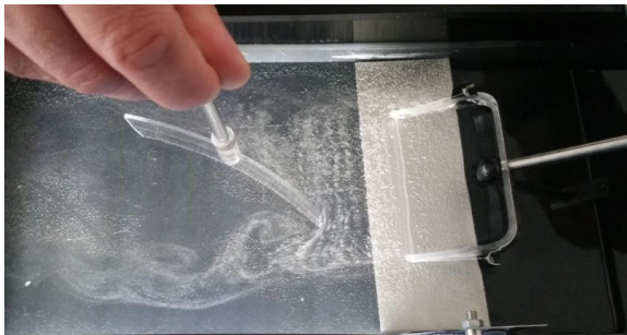
Slika 8. Opstrujavanje fluida oko zaobljenog tijela – PRIMJER 3 [6]
