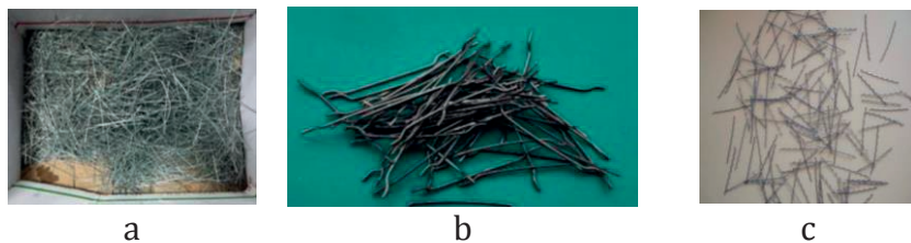
Slika 1. Različite vrste čeličnih vlakana: ravna vlakna [1] (a), vlakna s kukastim krajem [6] (b) i valovita vlakna [2] (c)
