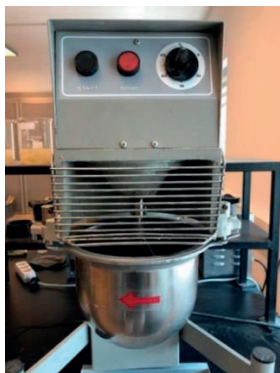
Slika 1. Miješalica za pripremu cementnog morta
