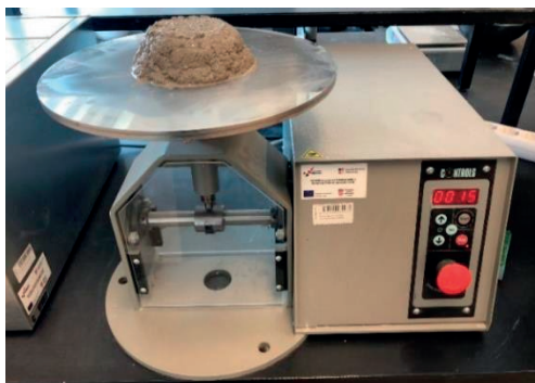
Slika 4. Potresni stolić za ispitivanje konzistencije cementog morta rasprostiranjem
