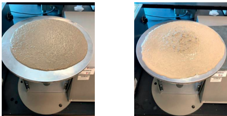
Slika 6. Obradivost (izražena kroz promjer rasprostiranja) svježeg cementnog morta za uzorke s 0,5 % SP (lijevo) i 1 % SP (desno)
