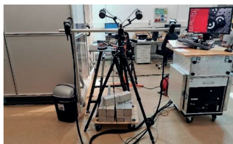
Slika 1. Potresni stol Quanser ST-III (lijevo) i optički mjerni sustav GOM Aramis 4M (desno)
