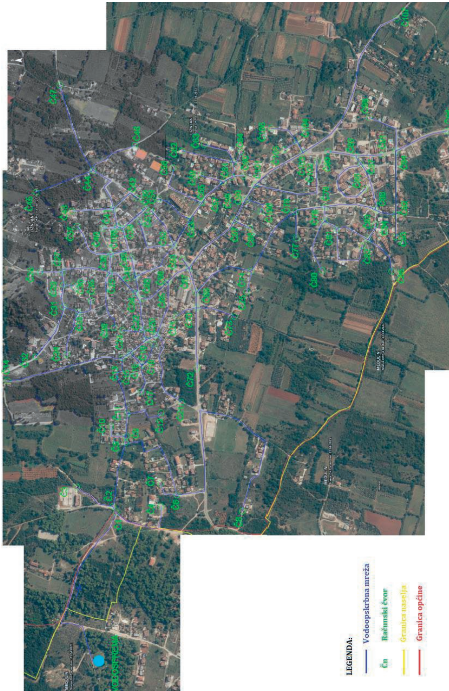
Slika 3. Prikaz postavljene granaste vodoopskrbne mreže za naselje Ližnjan u Istri
